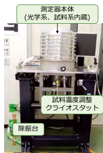
図1 熱膨張計システムの外観 光学系、試料系はチャンバー内に内蔵され、測定は減圧He雰囲気中で行われる。
