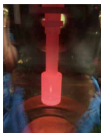
炉内で高温に加熱された治具
