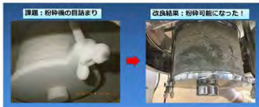
一般的な粉砕機を使用した破碎造粒試験結果
