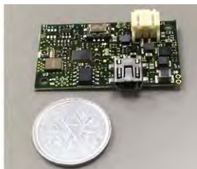
開発したRF LSIチップと実装基板(移動局)
